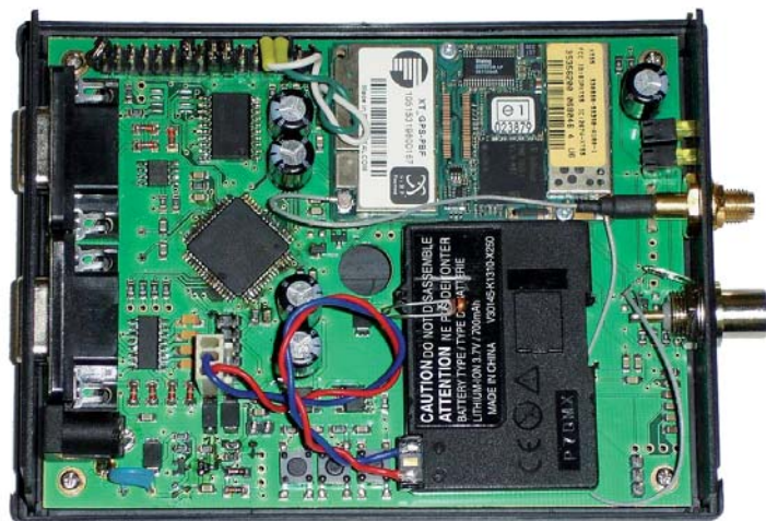
Zařízení pro GPS sledování vozidel pomocí GSM/GPRS sítě
