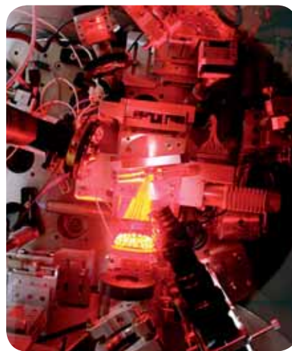
Pohled do interakční komory laserového systému PALS při experimentu s plazmovým rentgenovým laserem
