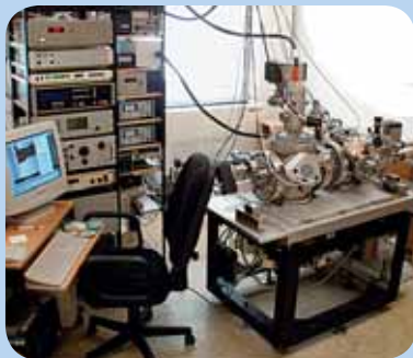
Ultravysokovakuový rastrovací nízkenergií elektronový mikroskop pro studium čistých a definovaných povrchů.
