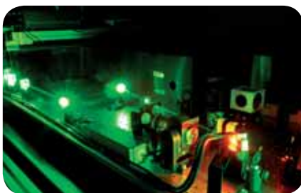
Zesilovač 20 TW, Ti:safírového laseru.
