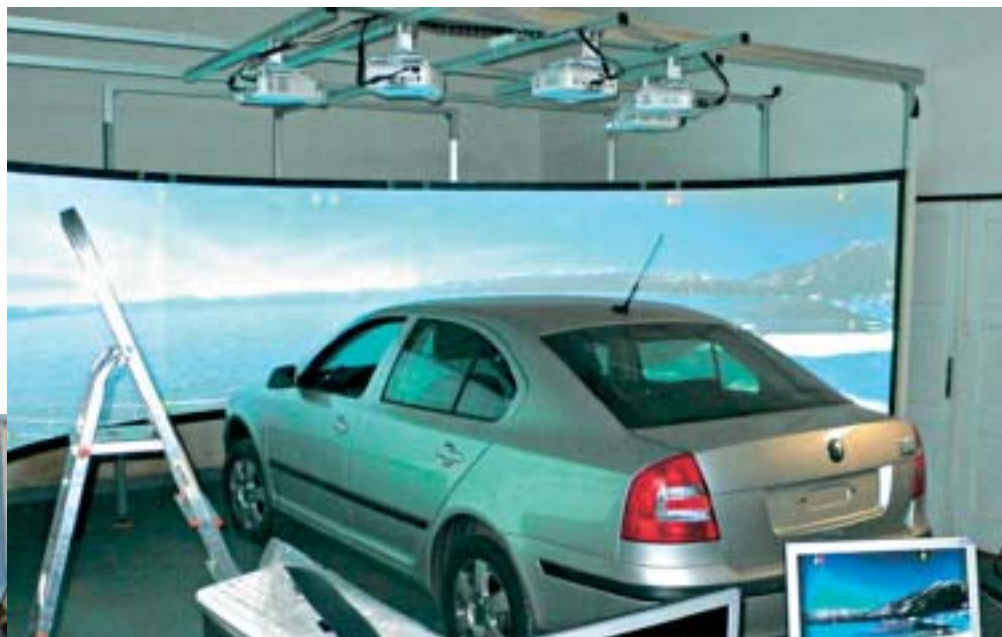
Vozový simulátor pro výzkum únavy řidičů
