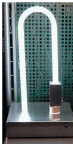
ANTÉNA z radaru po vypnutí elektřiny zmizí.
