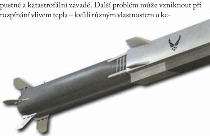
X-51 A SRAMJET ENGINE DEMONSTRATOR (nahore) TESTUJE HyTech scramjet amerického letectva v roce 2009. Prototyp nejnovějšího scramjetu amerického letectva (vpravo) nedávno ukončil sérii pozemních testů ve vysokoteplotním tunelu v NASA Langley Research Center.
