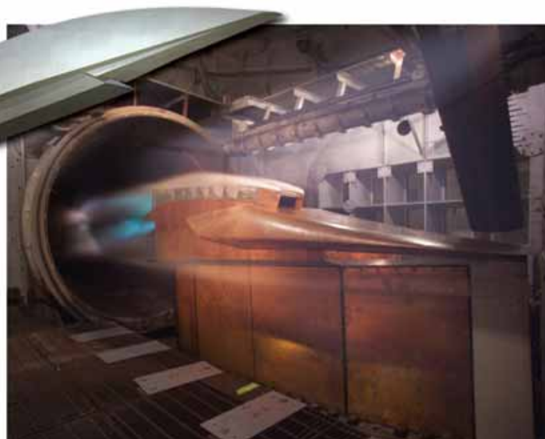
X-51 A SRAMJET ENGINE DEMONSTRATOR (nahore) TESTUJE HyTech scramjet amerického letectva v roce 2009. Prototyp nejnovějšího scramjetu amerického letectva (vpravo) nedávno ukončil sérii pozemních testů ve vysokoteplotním tunelu v NASA Langley Research Center.
