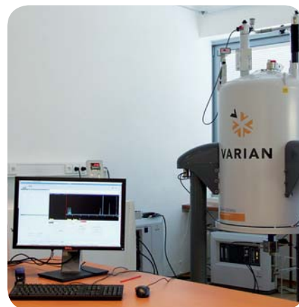
NMR spektrometr – přístroj sloužící k určení struktury chemických sloučenin
