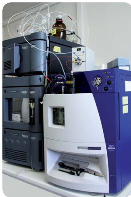
Ultravysokoučinná kapalinová chromatografie s hmotnostním detektorem (přístroj je schopen pracovat s množstvím vzorku v řádu ng – 10 -9 g)
