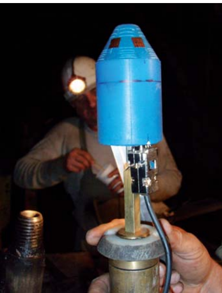
Kónická sonda pro měření napětí v horninách, zkonstruovaná v ústavu.
