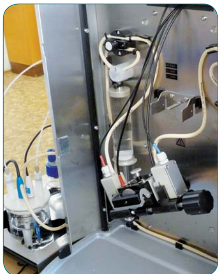
Elektrokinetický analyzátor pro stanovení zeta potenciálu na povrchu pevných látek, planárních vzorků, vláken či prášků
