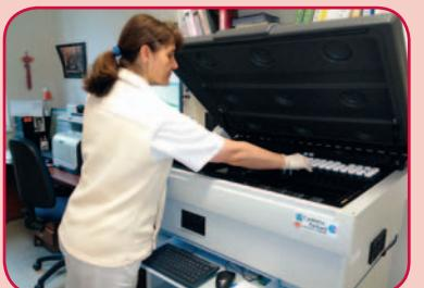
Práce s přístrojem na měření radioaktivnosti ve vzorcích z biologických tkání
