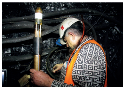
Napětová sonda, vyvinutá na ÚGN, připravená pro instalaci do vrtu v uhelném dole
