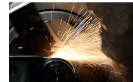
Soustružení titanu vysokorychlostním abrazivním vodním paprskem
